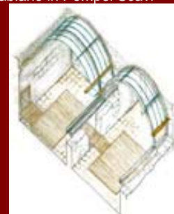
disegno 2 – La nuova copertura in policarbonato progettata per il Tepidarium e Calidarium
